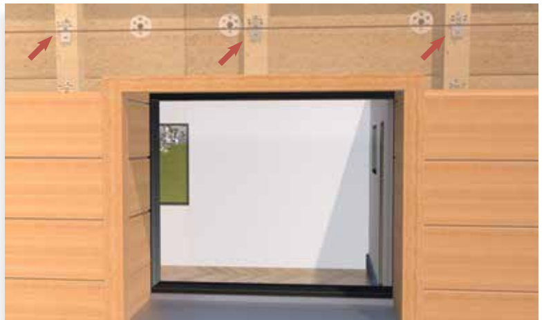
Fassadenprofile direkt über Fenstern und Türen sollten ebenfalls zusätzlich verschraubt werden.
