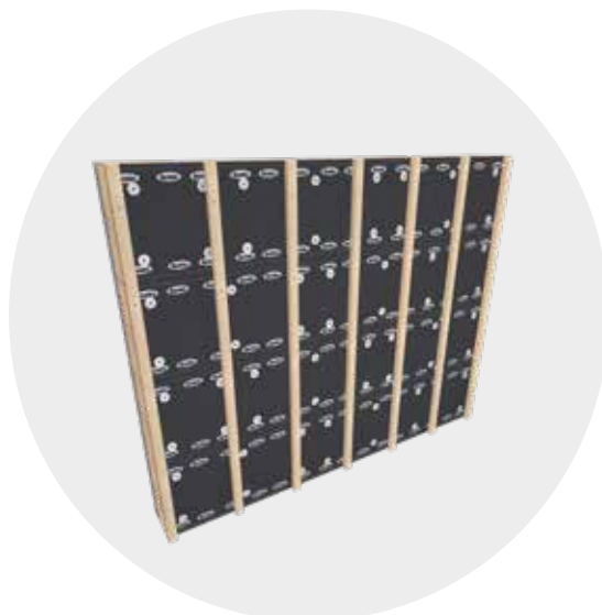
Aufbau einer Unterkonstruktion
